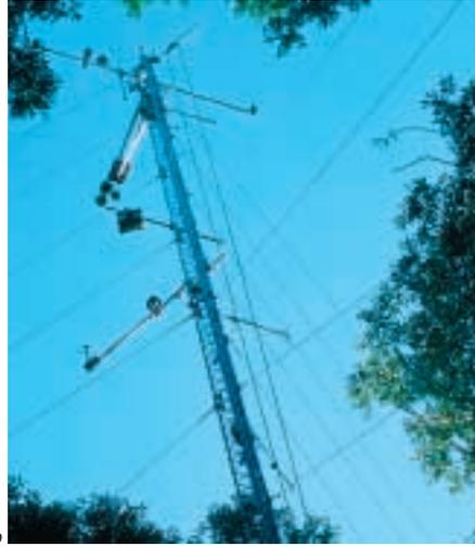
Abb. 2: Messmethoden zur Bestimmung des CO<sub>2</sub>-Austauschs zwischen Atmosphäre und Ökosystem. a) Messung des Stammumfangs, um über die Holzvorräte den Kohlenstoffgehalt zu ermitteln. b) Messturm mit Sensoren, die es erlauben, die CO<sub>2</sub>-Flüsse mit der Eddy-Kovarianz-Methode zu bestimmen.
