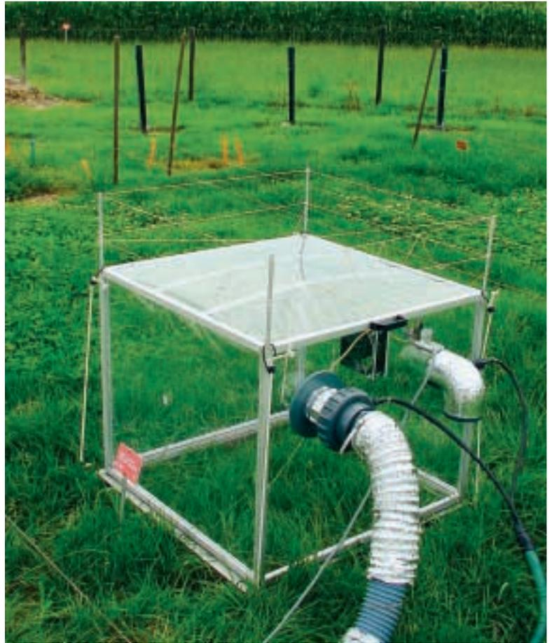
Abb. 2: Transparente Kammern werden verwendet, um den Netto-CO<sub>2</sub>-Austausch des Ökosystems zu messen.
