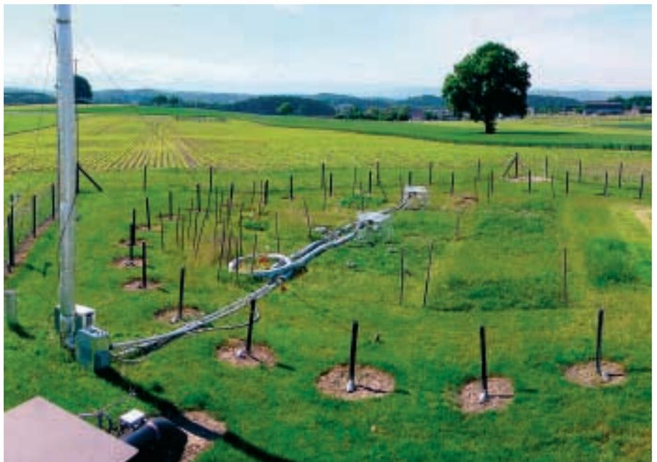
Abb. 1: Die Luft über dem Wiesenökosystem wird mit CO<sub>2</sub> angereichert, das aus den ringförmig angeordneten schwarzen Röhren austritt und mit dem Wind über der Versuchsfläche verteilt wird.
